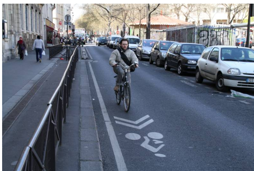
Lokální zúžení profilu vozovky, kde nelze vyznačit cyklistický pruh, avšak cyklista a vozidlo se stále mohou bezpečně míjet – koridor pro cyklisty lze legálně pojíždět rozměrnějšími vozidly (BUS, HZS, údržba, popeláři atd.) - Francie (Paříž)
